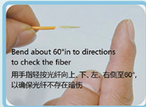
Check the fiber 1.6 检查光纤是否损伤
