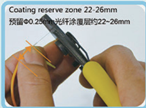
Strip the \Phi 0.25 mm fiber coating layer 1.5 剥去 \Phi 0.25 mm光纤涂覆层
